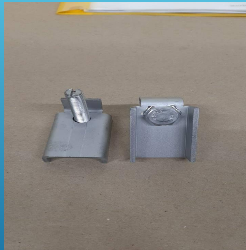
Деталь после покрытия Хим.Пас. по нержавеющей стали
